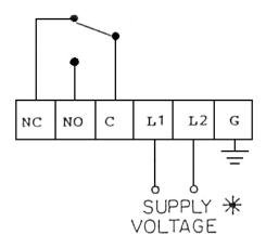
\*NOTE: EACH LS 2000 POWER SUPPLY IS INTENDED FOR ONLY ONE SUPPLY VOLTAGE. THIS VOLTAGE IS PRINTED ON THE POWER SUPPLY BOARD.
